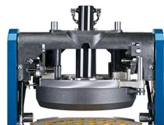
El sistema divisor de baja presión cuida la masa y no requiere esfuerzo físico alguno del operador.
